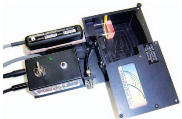
Bild 2: Foto des PORTA-LIBS 2000 Systems: Probenkammer, Laser und Triggerregelung
